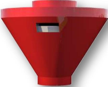
هذا الدلو هو الذي يقيس الإسمنت المطلوب الأتي عبر هيليزون من سيلو الإسمنت ويحتفظ به. و طاقتها الإستيعابية 100 كيلو غرام.تقوم بتفريغ الإسمنت عن طريق مفتاح الضغط الهوائي. موجودة فوق الخلاط مباشرة. يتحكم في مستواها. يتحكم فيه بواسطة أزرار إبدء-توقف في لوحة الكهربائية. يتم عيار قياس الإسمنت عبر زجاج مؤشر المستوى. تتم عملية التفريغ و التحكم عن طريق أيادي الضغط الهوائي.
