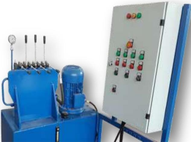
اللوحة الكهربائية للماكينة هذه اللوحة مجمع فيها جميع الأجزاء الكهربائي. صممت على أساس تحكم المشغل منها. يمكنها تثبيت العطل و الأخطاء. عند حالات الطوارئ توجد زر توقف للحفاظ على الوحدة. هذه اللوحات مصنوعة من ماركات SCHNEIDER و SEIMENS. لكل محرك يوجد صمامات كهربائية مستقلة. يستعمل العداد الزمني لماركة schneider لتحكم في توقيت كل عملية.
