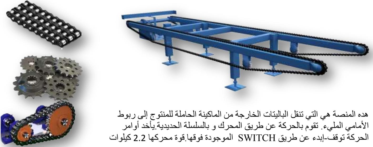
هذه المنصة هي التي تنقل الباليئات الخارجة من الماكينة الحاملة للمنتوج إلى ربوط الأمامي المليء. تقوم بالحركة عن طريق المحرك و بالسلسلة الحديدية يأخذ أوامر الحركة توقف-إبدء عن طريق SWITCH الموجودة فوقها. قوة محركها 2.2 كيلوات
