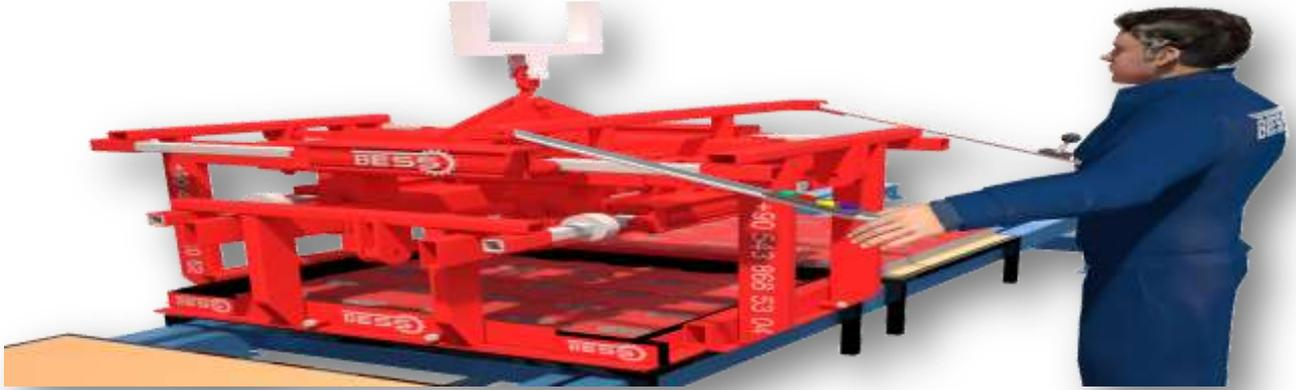
يقوم بتجميع المنتج عن الذي محمول فوق الباليت و الموجود في ربوط الخلفي لتفريغ والأتي من غرفة التجفيف ويضعه في الشحن EURO عن طريق المشغل. تتم حركته عن طريق الإشتغال بنظام الضغط الهوائي. تتم عملية التجميع في نقطة واحدة و يوجد فوقه محرك و معلق بعمود حديدي الذي يسهل حركة يمين يسار و فوق و تحت. قوة المحرك 0.2 كيلوات.
