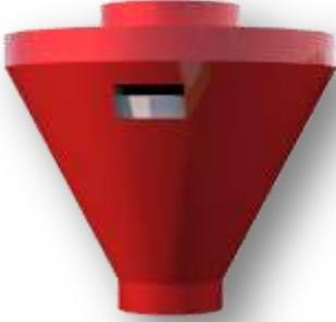
هذا الدلو هو الذي يقيس الإسمنت المطلوب الأتي عبر هيليزون من سيلو الإسمنت ويحتفظ به. و طاقتها الإستيعابية 50 كيلو غرام. تقوم بتفريغ الإسمنت عن طريق مفتاح الضغط الهوائي. موجودة فوق الخلاط مباشرة. يتحكم في مستواها. يتحكم فيه بواسطة أزرار إبدء-توقف في لوحة الكهربائية. يتم عيار قياس الإسمنت عبر زجاج مؤشر المستوى. تتم عملية التفريغ و التحكم عن طريق أيادي الضغط الهوائي.
