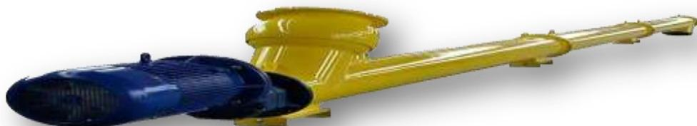
وظيفتها نقل الإسمنت من سيلو الى دلو وزن الإسمنت قطرها ( 219 ميليمتر 8)، نوعها ماركة (WAM) قوة المحرك 9.2 كيلووات . اما الانبوبة الحلوونية الاخرى تضخ الاسمنت الى الخلطات سواء الى الخلطة الخشنـة ام الى الخلطة الناعمة وذلك حسب الطلب لأنها بميزة الحركة على الجانبين.
