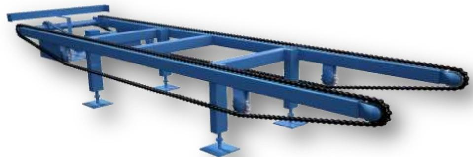
هذه المنصة هي التي تنقل البالباتن الخارجة من الماكينة الحاملة للمنتج إلى ربوط الأمامي المليء. تقوم بالحركة عن طريق المحرك و بالسلسلة الحديدية. يأخذ أوامر الحركة توقف-إبدء عن طريق SWITCH الموجودة فوقها.
