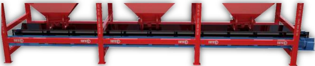
هذا السیر مهمته توصیل المواد الاولیة ، موقعها تحت خزان المواد الاولیة ،الهیكل مصنوع من الواح حديد مختلفة ومن مواسير حديدية مقاس 40\*80\*3 مم مطابقة مواصفات (DIN) وبجودة (ISO 9001) لكي تكون مقاومة اکثر تم تصنيعها من الحديد المبروم ، وضعت السلندرات تحت السیر كل 90 سم لغرض التناسق وهي قابلة الفك والتتعديل ايضا و لا تسمح بتدفق المواد ، جلة السیر سمکها 8 مم من النسیج المحکمة والرولات 3"(89mm). تتحرك عن طريق مجموعة مخفضات وقوة المحرك 2.2 كیلووات.
