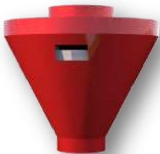
هذا الدلو هو الذي يقياس الإسمنت المطلوب الأتي عبر هيليزون من سيلو الإسمنت ويحتفظ به. و طاقتها الإستيعابية 100 كيلوغرام. تقوم بتفریغ الإسمنت عن طريق مفتاح الضغط الهوائي . موجودة فوق الخلط مباشرة. يتحكم في مستواها. يتحكم فيه بواسطة أزرار إبداء-توقف في لوحة الكهربائية. يتم عيار قياس الإسمنت عبر زجاج مؤشر المستوى. تتم عملية التفريغ والتحكم عن طريق أيادي الضغط الهوائي.
